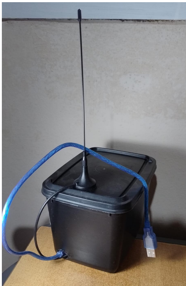
Figura 4 – Exemplo de protótipo implementando a lógica exposta na Figura 2, com interfaceamento USB/Transceptor de um LoRa E32-433T20D (interface UART) integrado a um Arduino Mega e encapsulado em container plástico (caixa de sorvete).
